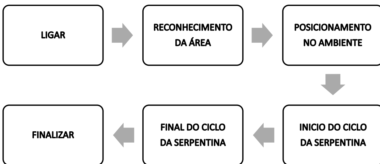
FIGURA 18 – Ciclo de funcionamento do dispositivo.
