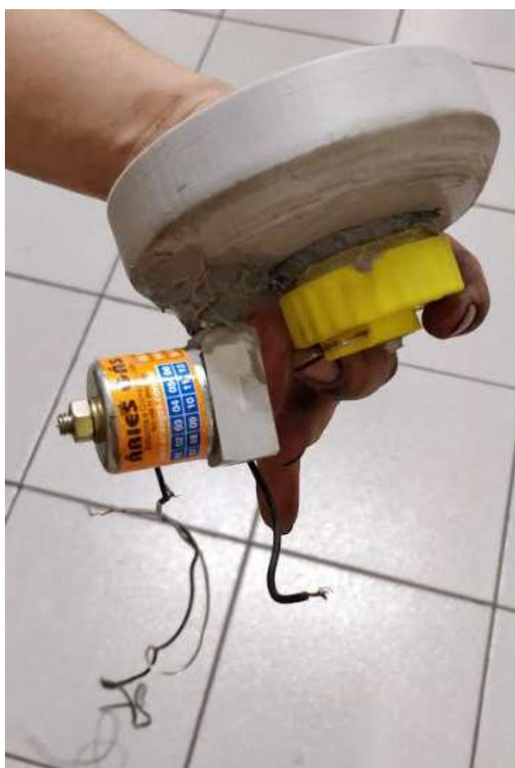
Figura 53 – Solenoide instalada na parte inferior
