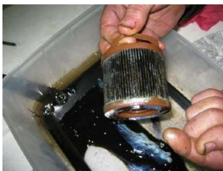
Figura 19: Filtro entupido por ação microbiana
