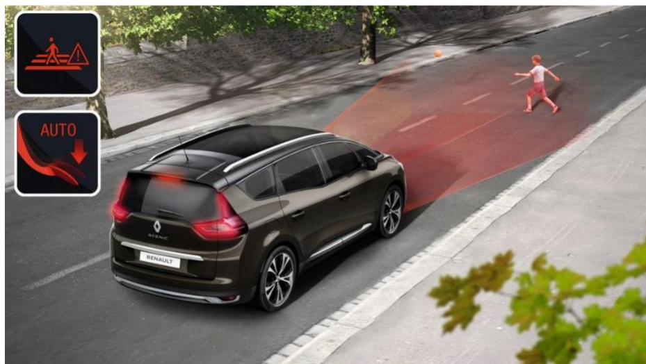
Figura 20: Sistema AEB funcionando com uma criança correndo na frente do veículo
