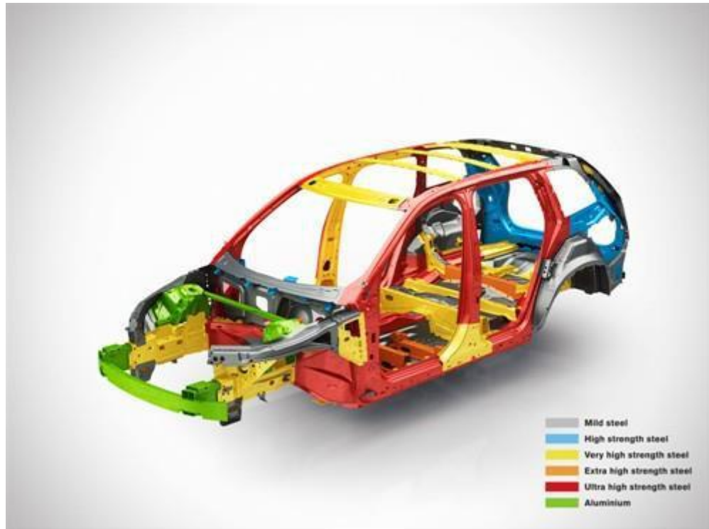
Figura 12: Materiais utilizados na carroceria de um veículo de passeio
