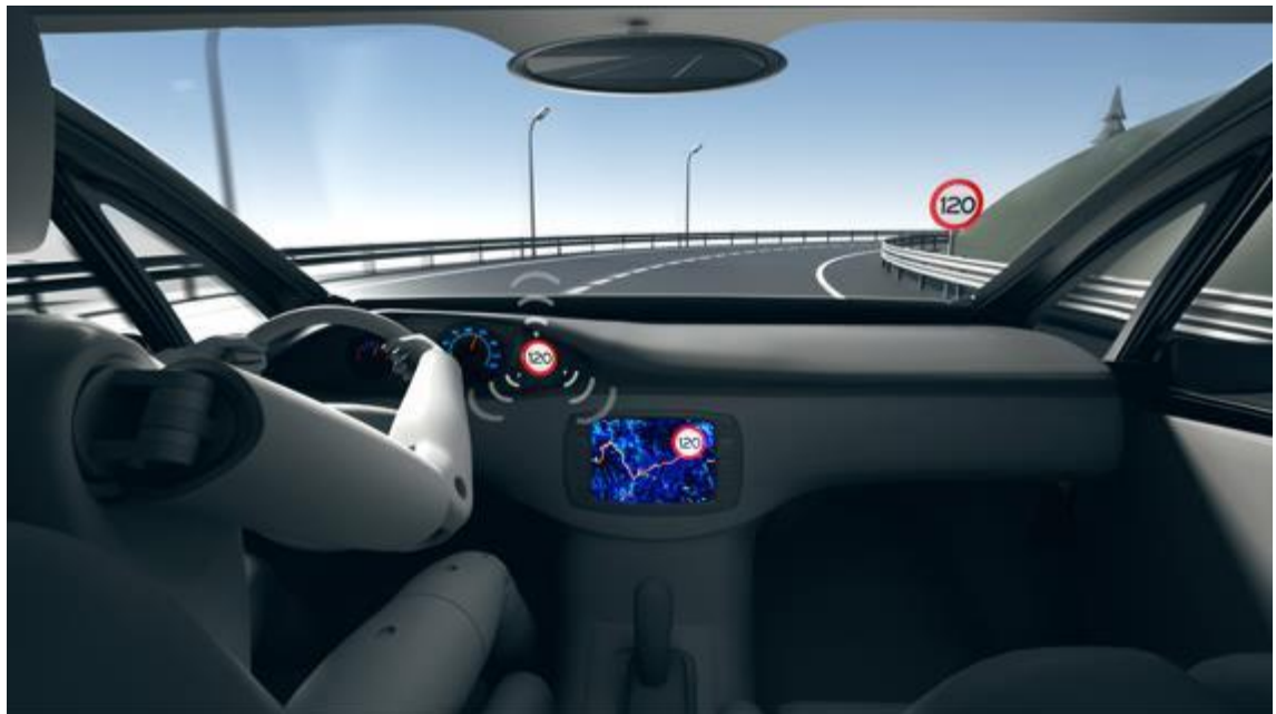
Figura 26: Desenho mostrando o assistente de velocidade em funcionamento por leitura de placas e/ou pela central de navegação.
