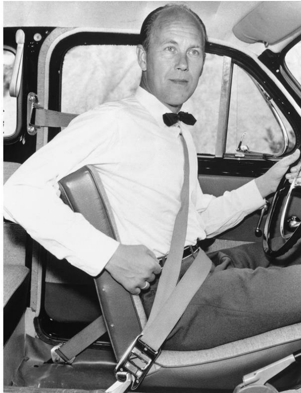
Figura 5: Nils Bohlin em 1959 em um carro Volvo com o cinto de três pontos.
