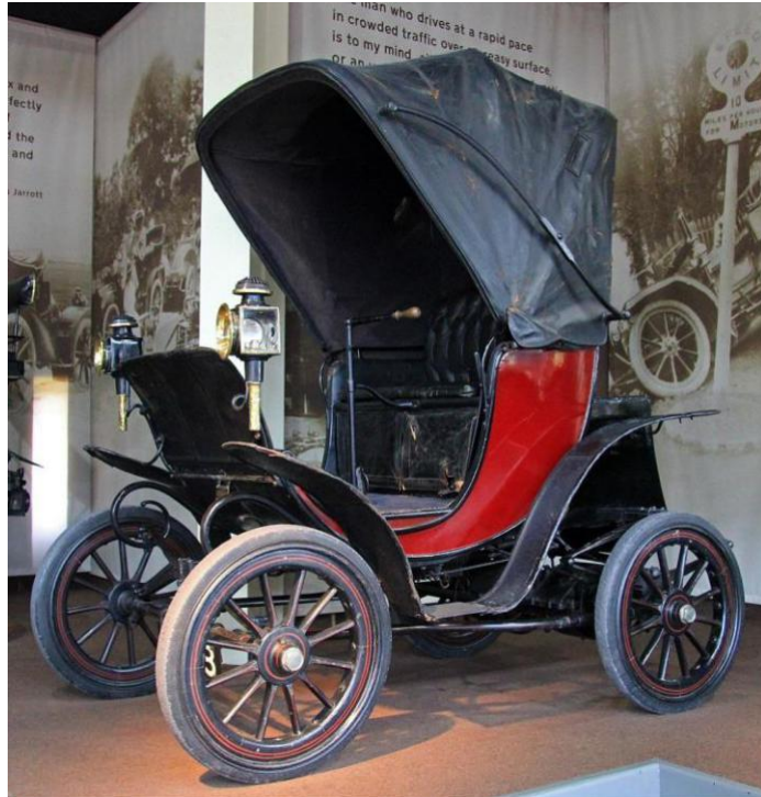
Figura 2: Columbia Phaeton de 1901 com faróis elétricos
