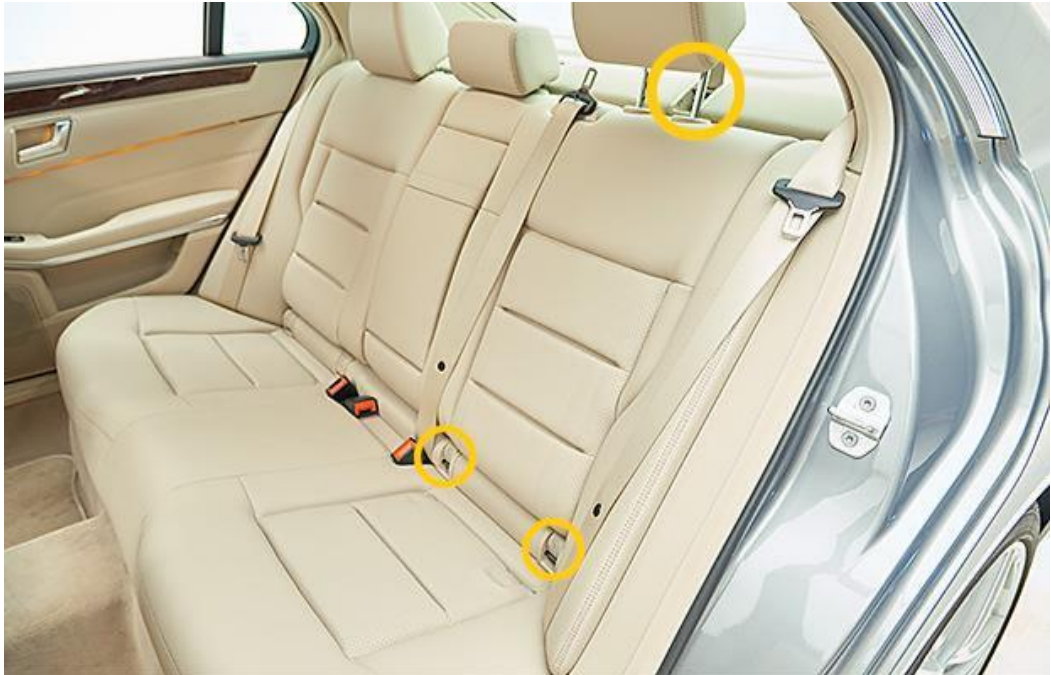
Figura 34: Pontos de fixação e amarração em um veículo
