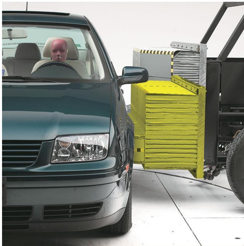
Figura 29: Em amarelo, a barreira usada pelo governo sobreposta à barreira mais alta, do IIHS
