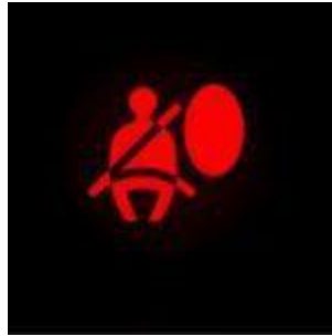
Figura 18: Luz indicadora do lembrete do uso do cinto de segurança
