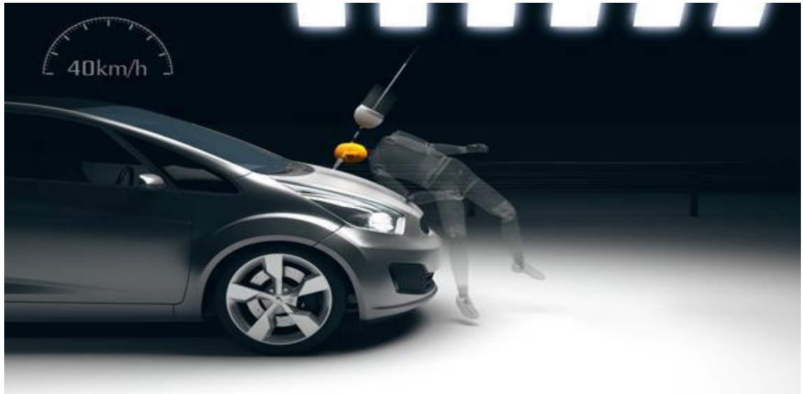
Figura 24: Desenho de um impacto frontal medindo os danos causados á cabeça do dummie .
