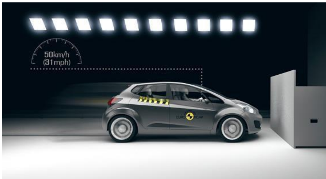
Figura 21: Desenho da simulação de teste de impacto frontal 100%
