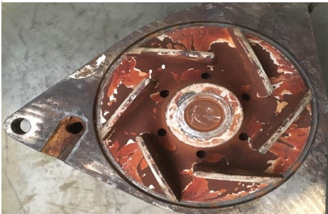
Figura 57: Bomba d'água impregnada com material metálico
