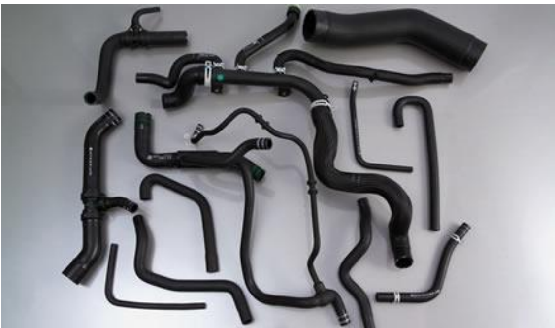
Figura 22: Mangueiras do sistema de refrigeração do motor
