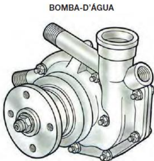
Figura 11: Bomba de água do sistema de arrefecimento de um MCI
