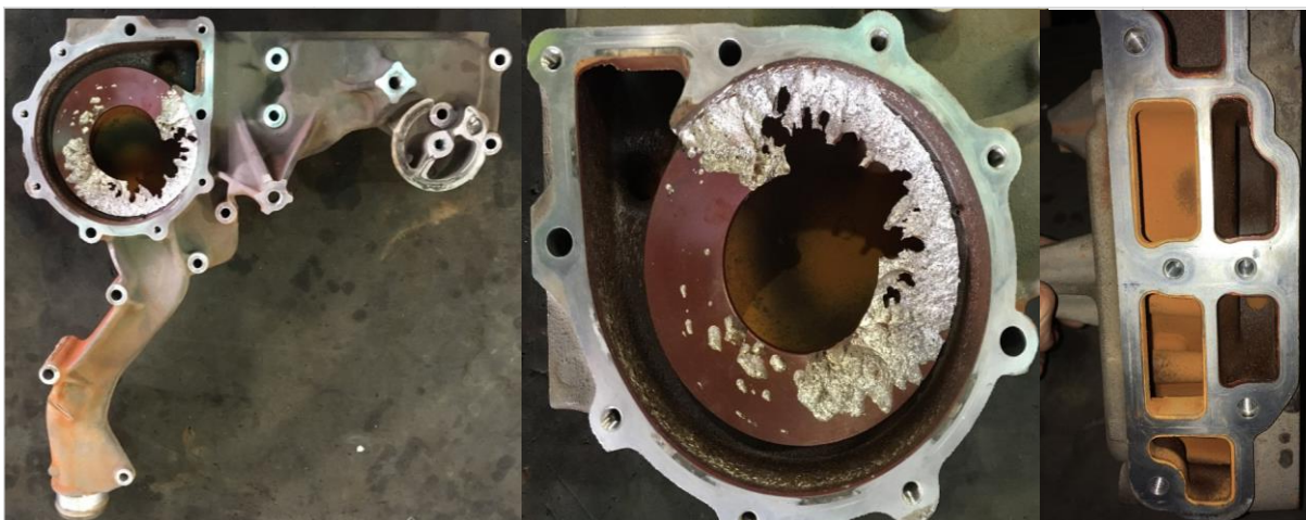
Figura 59: Cavitação na carcaça da bomba d'água
