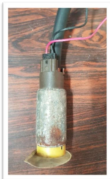
Figura 23 – Chicotes na bomba de combustível
