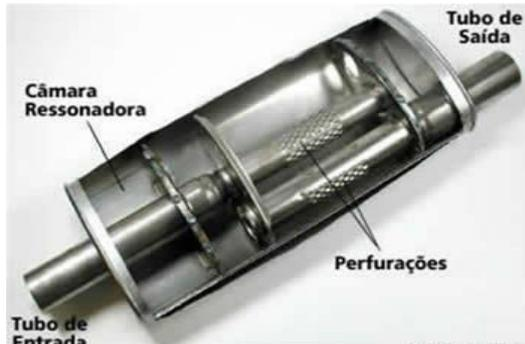
Figura 5- Sistema de atenuação de ruídos do escapamento
