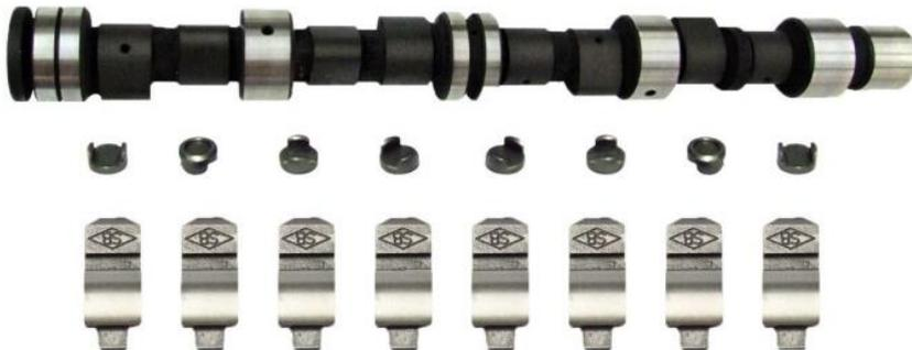
Figura 11- Comando de válvulas e balancins
