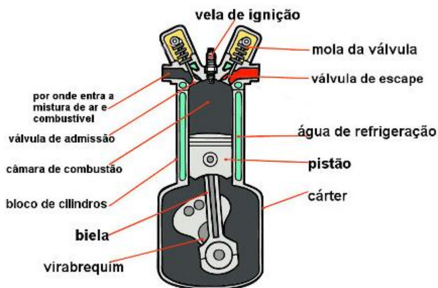
Imagem 2 - Principais componentes do motor de combustão interna
