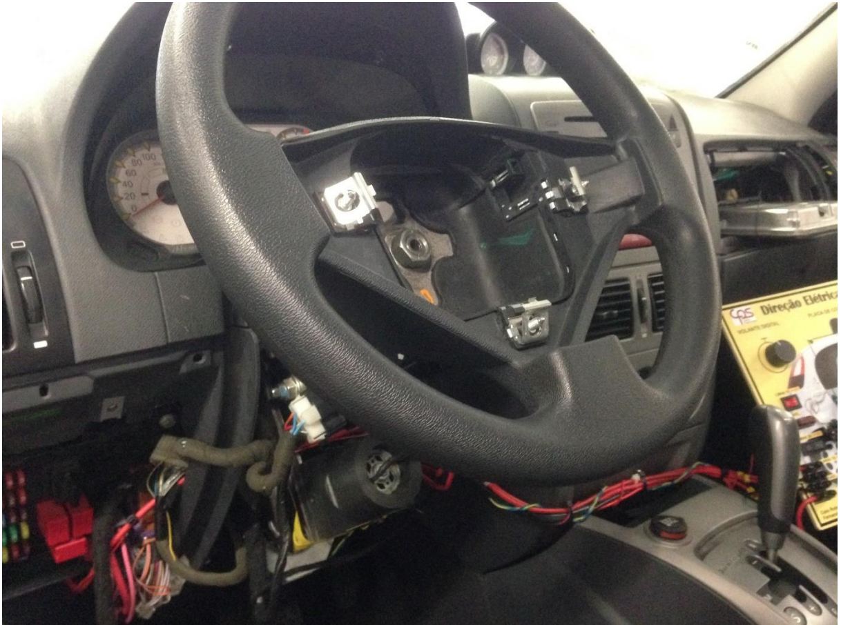
Figura 36 – Coluna de direção instalada no veículo.
