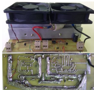
Figura 29 – Placa ponte H com MOSFET's canal P e N.
