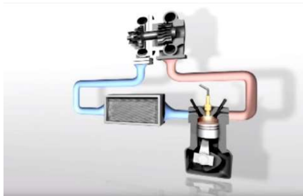
FIGURA 16- ESQUEMA DO TURBOCOMPRESSOR
