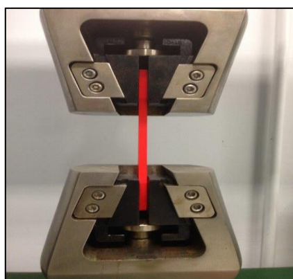
Figura 22 - Corpo de prova fixo ao equipamento de ensaios WDW-100E da Fatec Santo André
