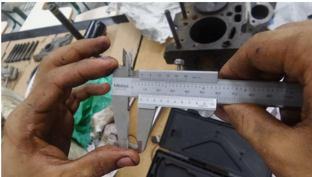
Figura 4.4 – Constatação da altura do conjunto êmbolo-biela em 7 mm.
