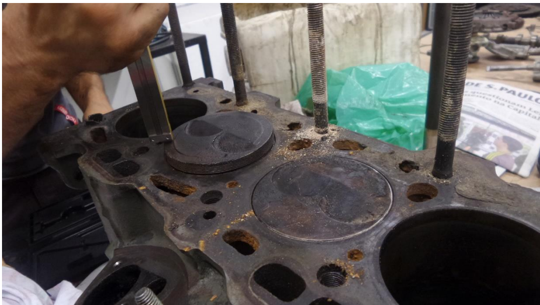
Figura 4.3 – Comparação da altura do conjunto biela êmbolo de 130 mm com conjunto de 132 mm.
