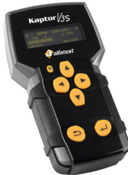
Figura 9, Sistema de leitura de DTC do sistema OBD do veículo (informações de diagnóstico).
