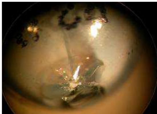
Figura 11: Lâmpada com vazamento de gás
