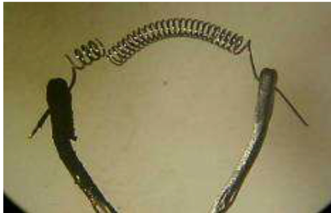
Figura 09: Filamento rompido por sobrecarga (aumento de tensão elétrica)
