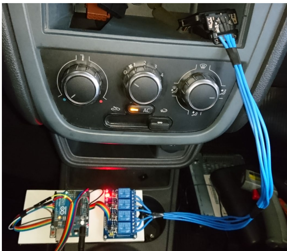
Figura 41 - Disposição dos componentes montados no interior do veículo.
