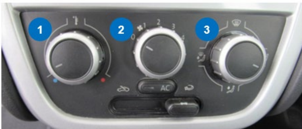
Figura 6 - Unidade de controle analógico do ar condicionado.
