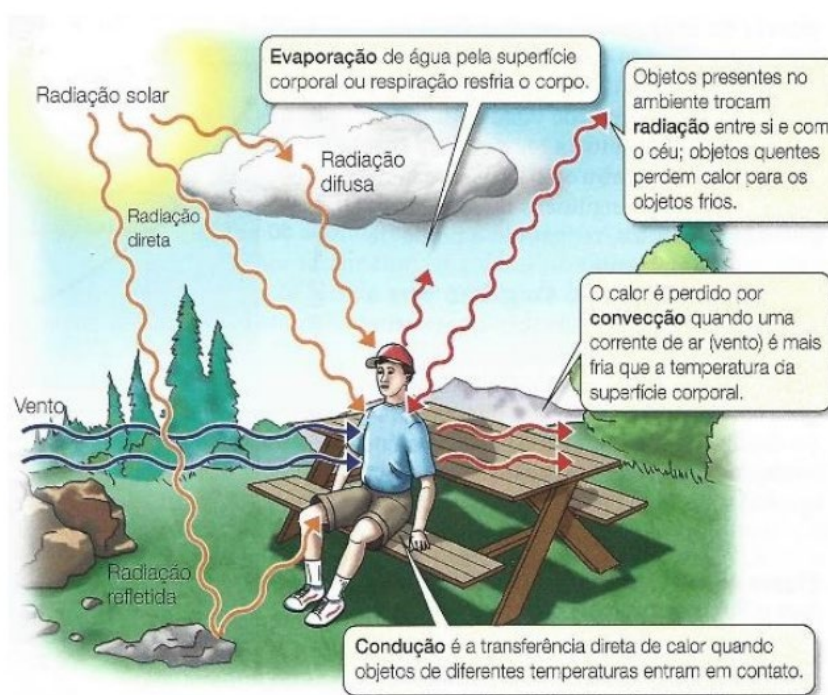
Figura 17 - Sistemas de trocas térmicas.
