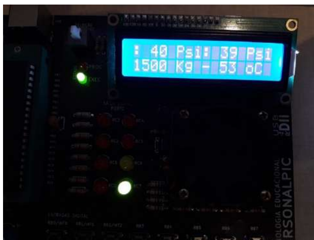
Figura 34 – Simulação do sistema com alta pressão nos pneus.
