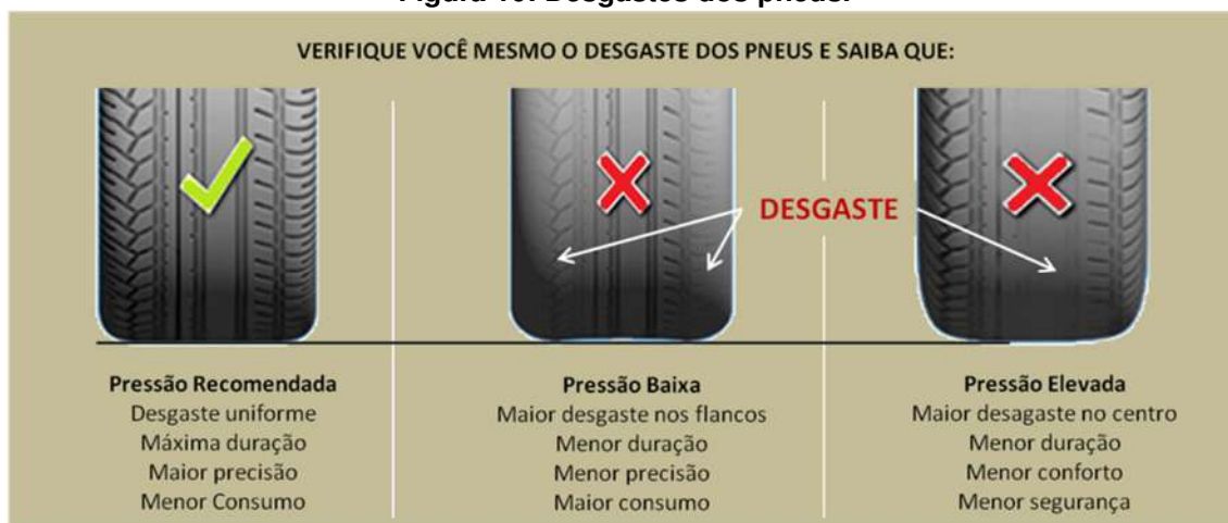
Figura 10: Desgastes dos pneus.
