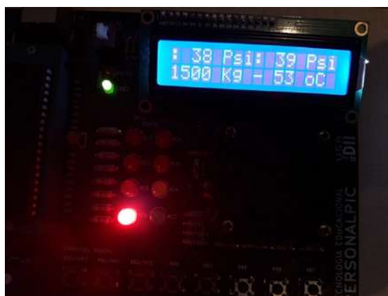
Figura 33 – Simulação do sistema com baixa pressão nos pneus
