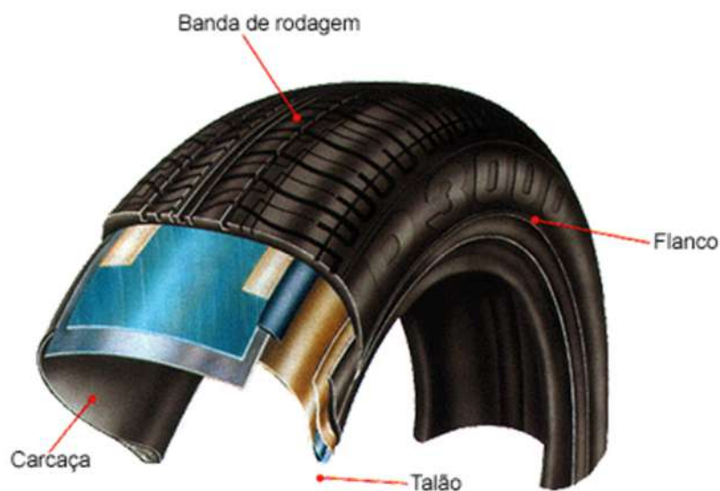
Figura 4: Partes do pneu.
