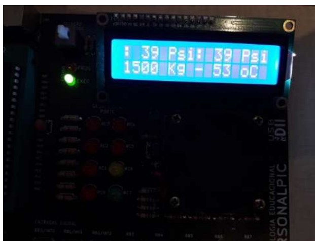
Figura 35 – Simulação do sistema com a pressão correta nos pneus.
