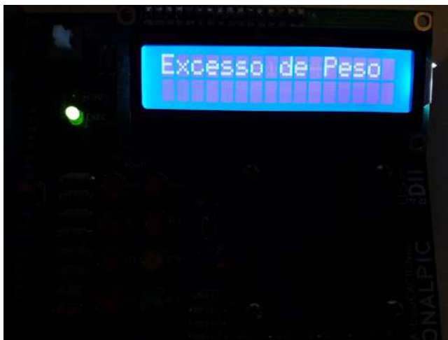
Figura 36 – Simulação do sistema com excesso de peso no veículo.
