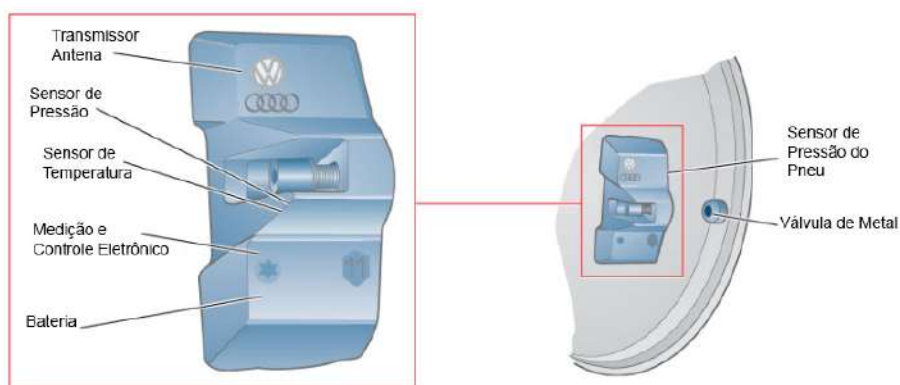
Figura 19 – Sensor de Pressão e Temperatura (Volkswagen e Audi).
