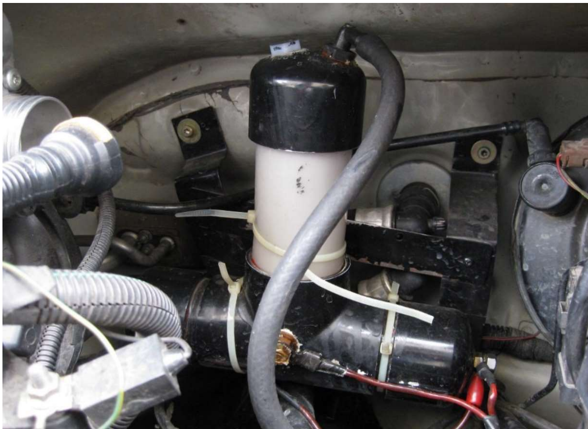
Figura 4 - Célula HHO - Citroen C3 2006 1.4 8V.
