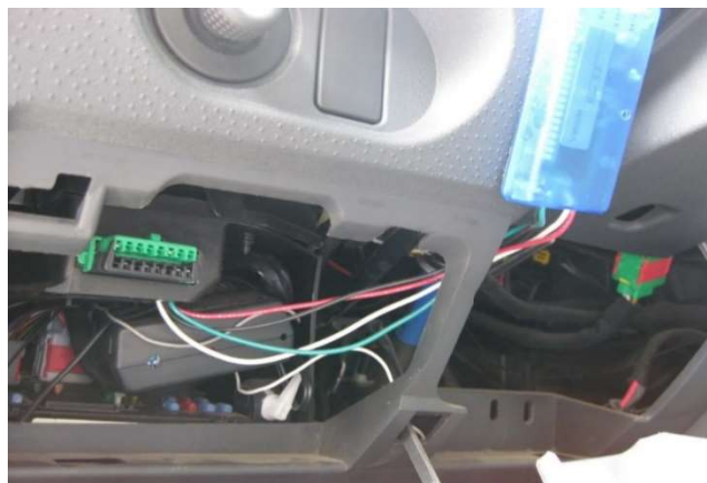
Figura 8 - Chip conectado à porta OBDII instalada no painel do C3
