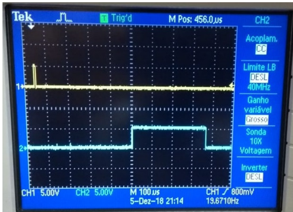
Figura 47 – Formas de Onda do Terceiro Corpo de Prova do Terceiro material.
