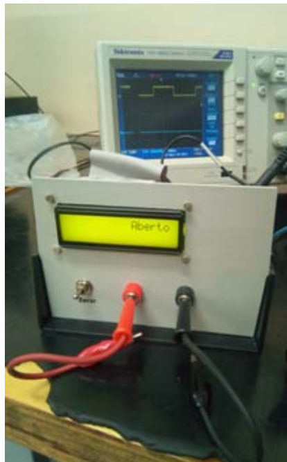
Figura 59 – Teste de circuito aberto
