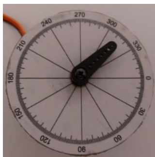
Figura 32 – servo-motor aberto em 45°.
