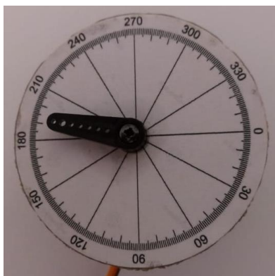
Figura 29 – Servo-motor aberto em 170°
