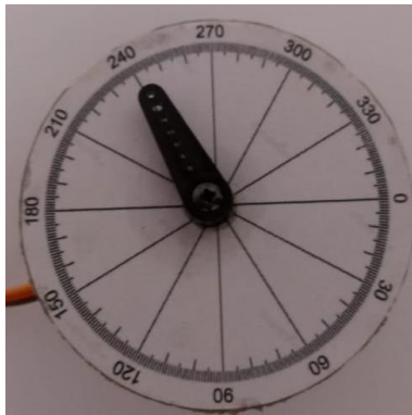
Figura 30 – servo-motor aberto em 120°
