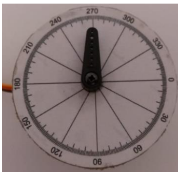
Figura 31 – servo-motor aberto em 90°.
