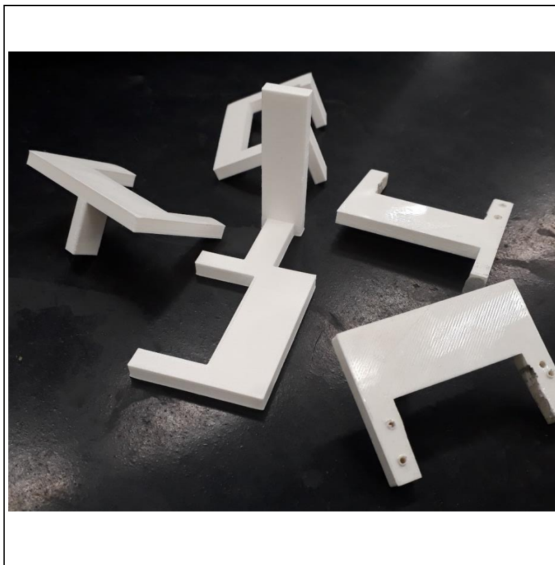
Figura 20 - Suportes para os servos motores feitos com impressora 3D
