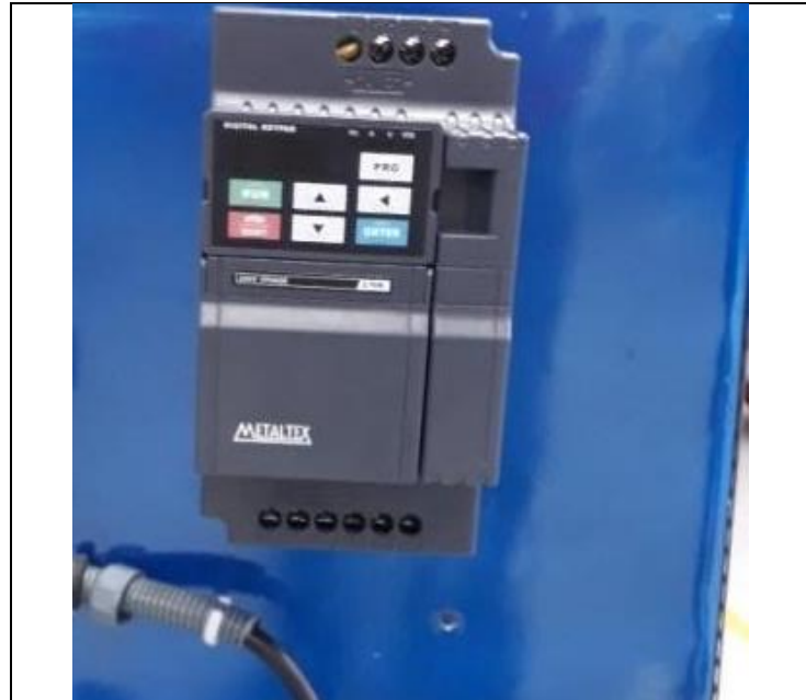
Figura 10 - Instalação do inversor de frequência a giga de teste
