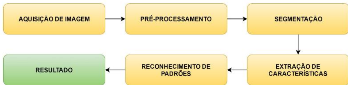
Figura 11 – Fluxo de um sistema de visão computacional
