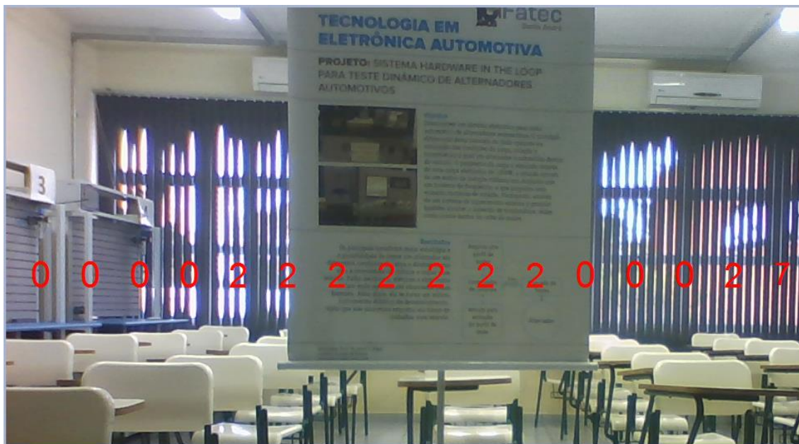
Figura 38 - Segundo teste realizado com uma luminosidade do ambiente menor, correspondente a 38 Lux.
