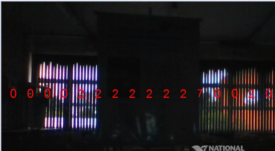
Figura 39 - Terceiro teste do sistema com alteração de luz do ambiente, nesse caso a intensidade luminosa era de 2 Lux.
