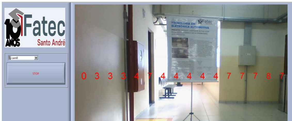
Figura 36 - Exemplo de medição da distância entre o sensor e o cartaz no ambiente estabelecido, pode-se observar a variação de luminosidade ao longo do corredor.
