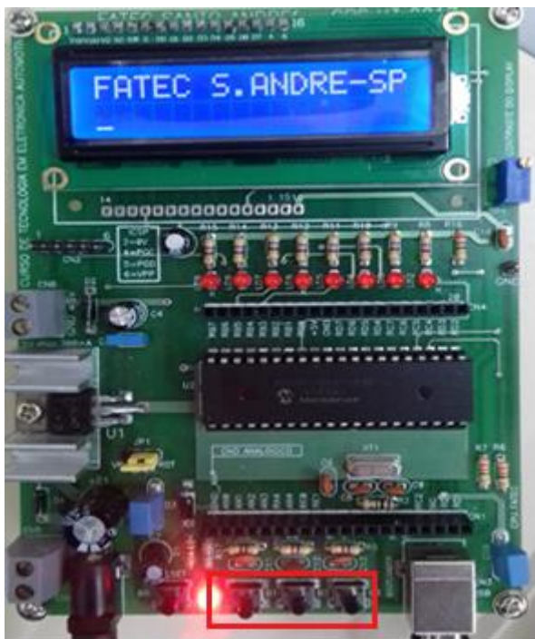
Figura 20 - Placa de desenvolvimento utilizada para comandar o servomotor por meio de pulsos "PWM", em destaque na parte inferior os botões b1, b2 e b3.
