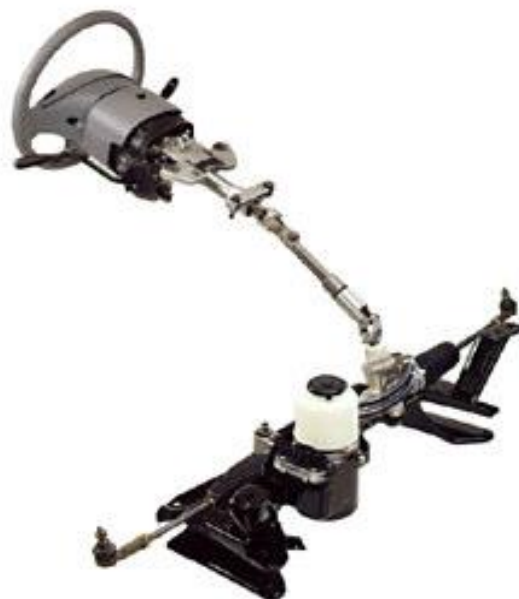
Figura 17 – Sistema de direção eletro-hidráulica.
