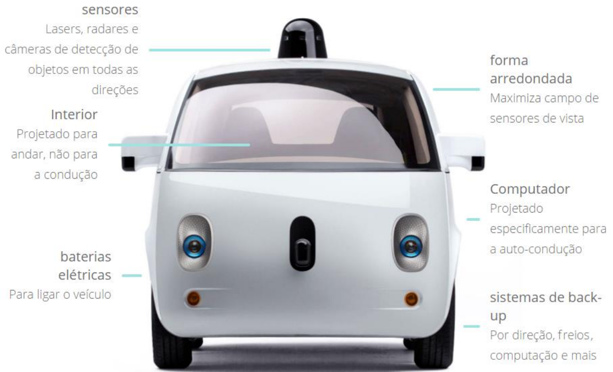
Figura 5 – Identificação dos dispositivos do veículo autônomo Google.
