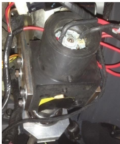
Figura 35 – Sistema montado (motor DC, conjunto de polias e correia).
