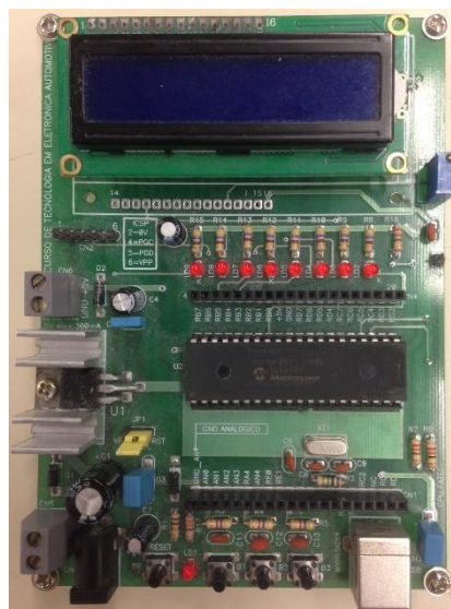
Figura 27 – Placa eletrônica com microcontrolador PIC 18F4550.
