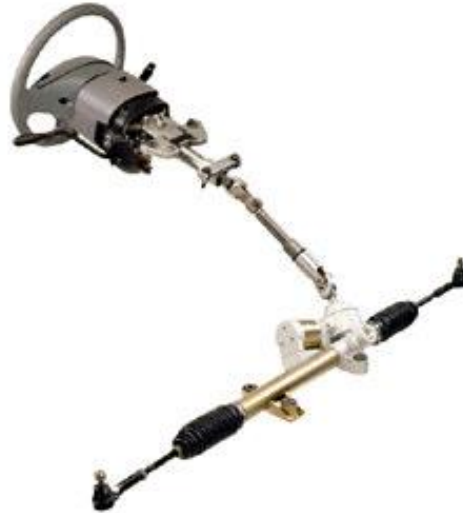
Figura 23 – Sistema pinhão elétrico.
