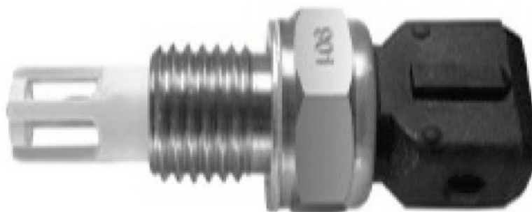
Figura 21 - Sensor de 3,3 k \Omega a 20°C, utilizado para medição do ar admitido e do motor.
