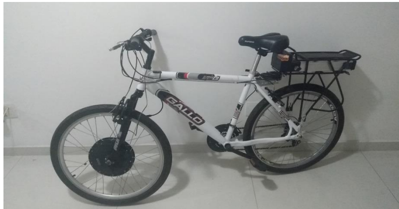
Figura 29 - Bicicleta Convertida para Eletrica.
