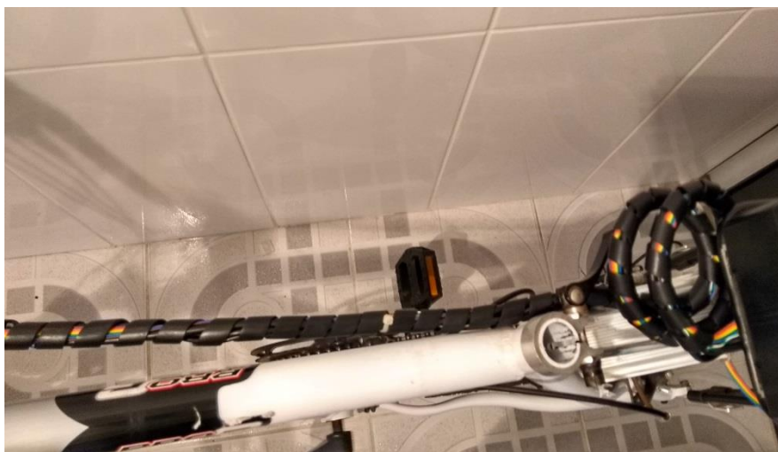
Figura 33 - Organização das cablagens.
