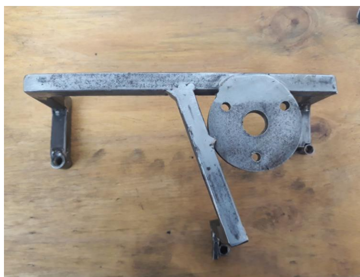
Figura 27: Suporte de fixação do motor elétrico
