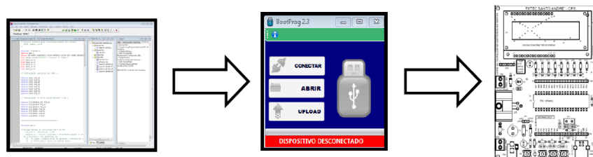
Figura 14 – Sequência para carregamento do firmware no Pic (Fonte: Os autores).
