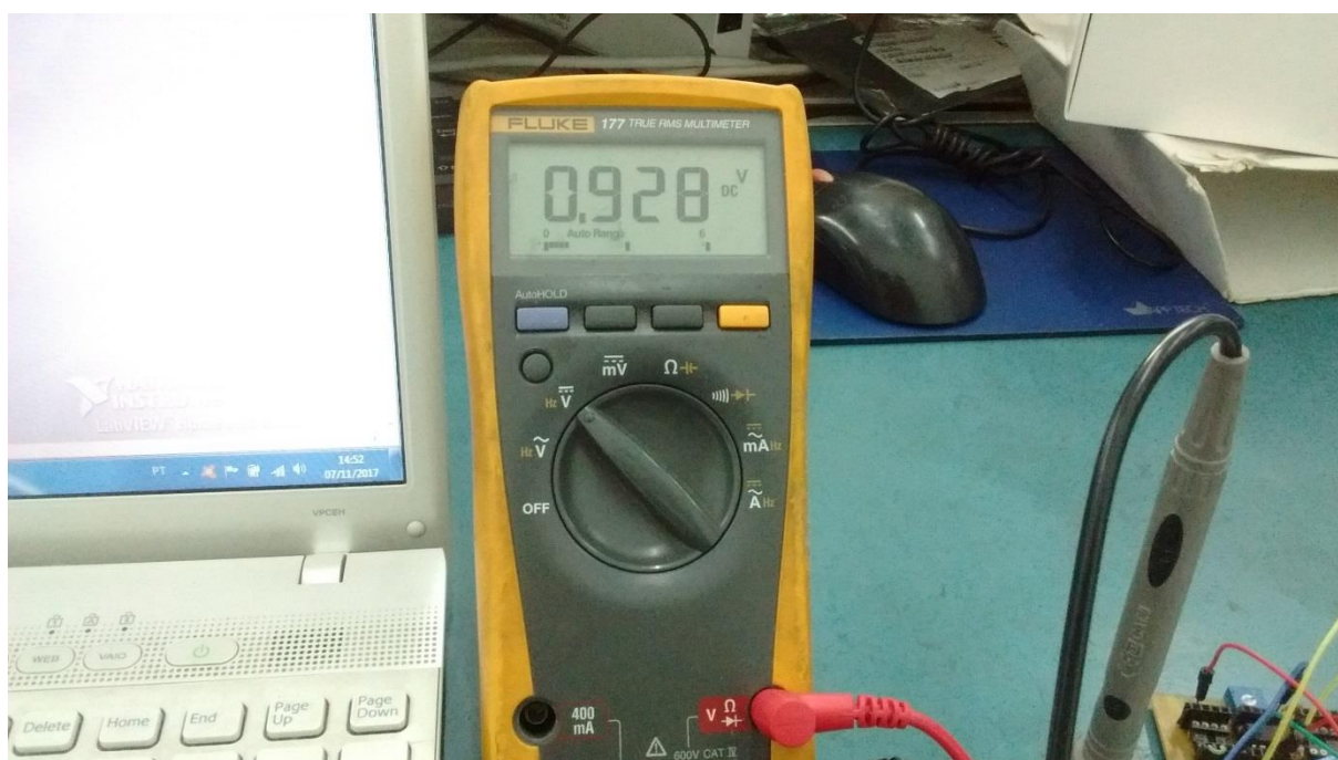
Figura 31- Leitura do Sinal com Ganho Quatro Efetuada Pelo Multímetro (Fonte: Os autores).
