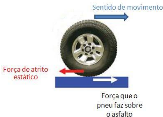
Figura 24 – Sentido de movimento da roda em relação as forças.
