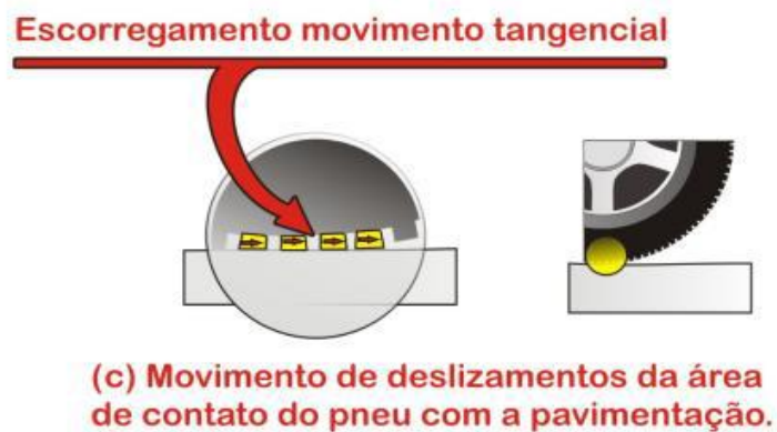
Figura 12 – Aparecimento de ruído nos pneus em virtude do deslizamento dos blocos.
