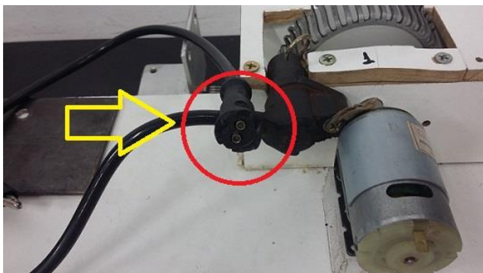
Figura 54 – Terminais do sensor de rotação que fornece o sinal senoidal parâmetro lido e utilizado pela ECU.
