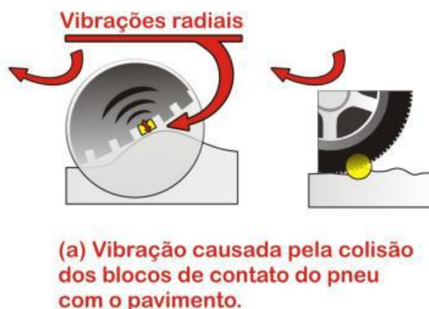
Figura 10 – Dissipação de energia na forma de calor e som.
