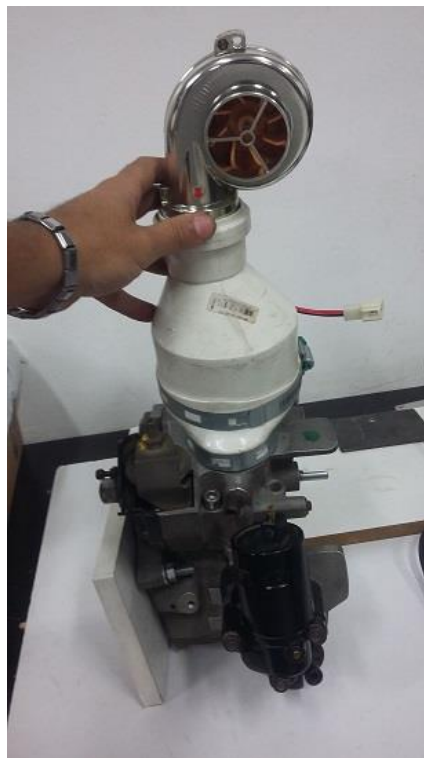
Figura 64 – Turbina montada na redução.
