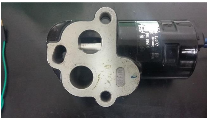
Figura 68 – Abertura da portinhola do atuador proporcional o sinal PWM.
