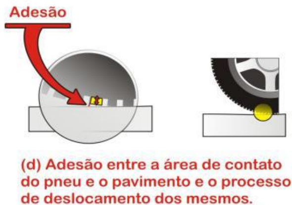
Figura 13 – Ruído causado por adesão do pneu com o pavimento.
