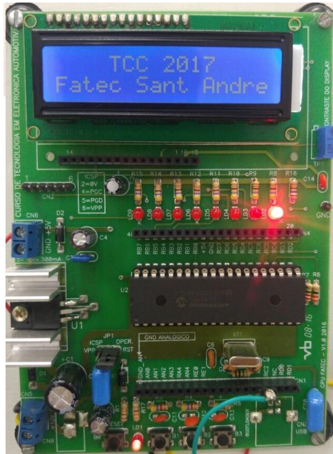
Foto 7: Placa com microcontrolador + display
