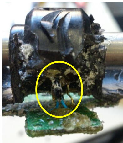
Foto 4: Sensor de Temperatura
