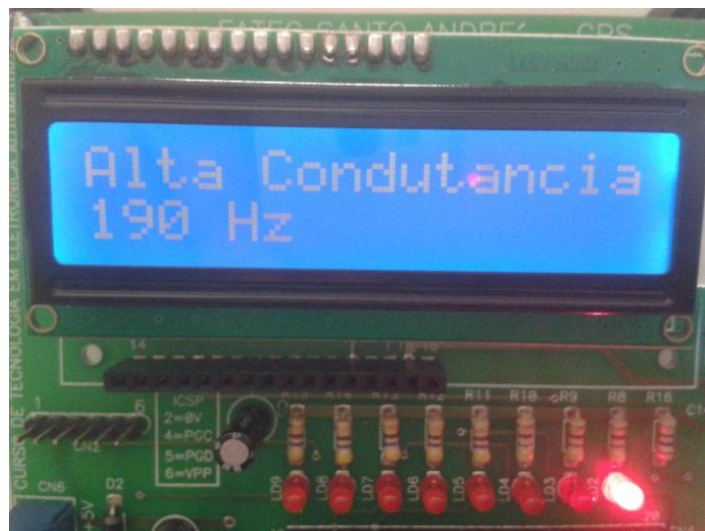
Foto 11: 4º Ensaio – 190Hz Frequência de erro
