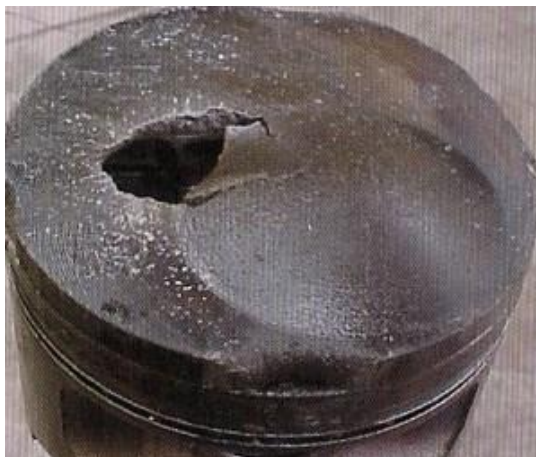
Foto 1: Cilindro danificado - Detonações
