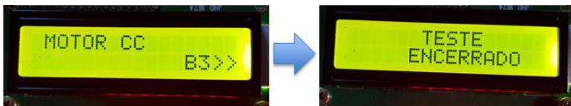
Figura 54: Sequência acusando curto-circuito no motor e finalizando o teste.
