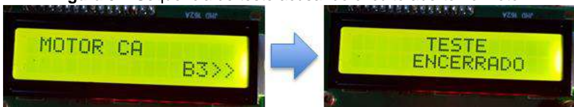
Figura 57: Sequência de teste acusando circuito aberto no motor.
