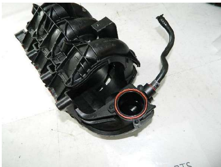
Figura 10: Coletor de admissão do Ford Ka 1.0 motor 3 cilindros.
