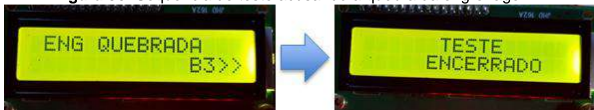
Figura 56: Sequência de teste acusando a quebra da engrenagem.
