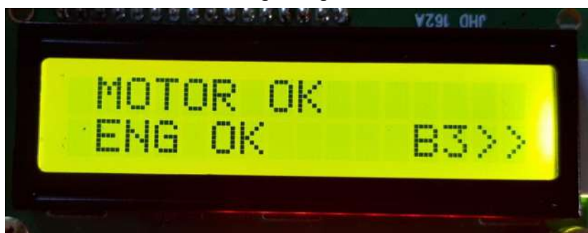
Figura 58: Sequência de teste validando motor e as engrenagens.
