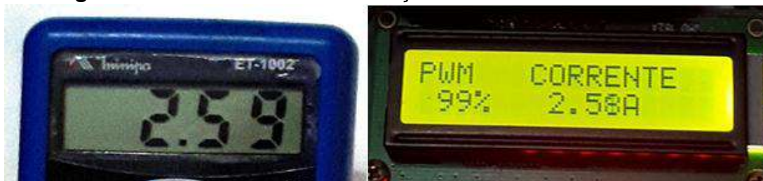
Figura 48: Corrente máxima alcançada no curto-circuito simulado.
