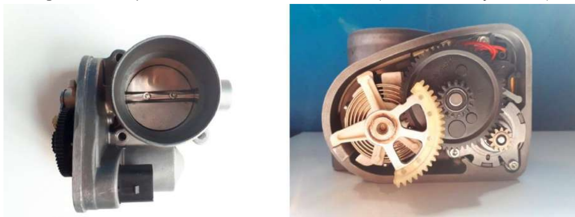
Figura 19: Corpo de válvula borboleta eletrônico (ano de fabricação 2008).
