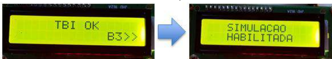
Figura 60: Término da sequência de testes TBI validado e habilitada a simulação.
