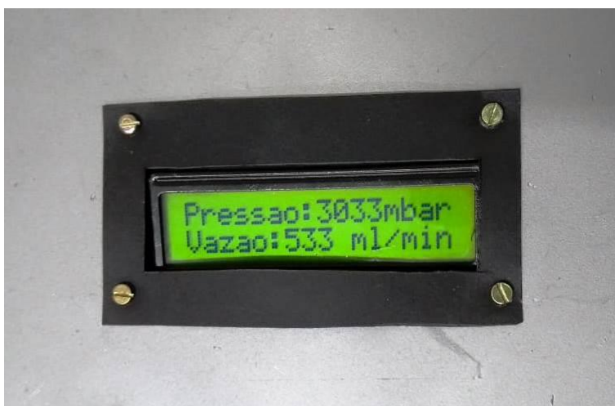
Figura 40: Apresentação dos valores de pressão e vazão medidos
