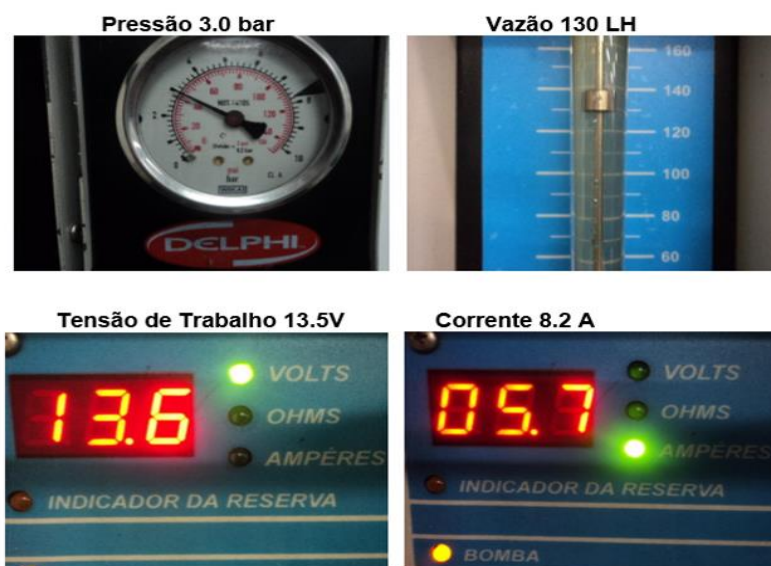
Figura 12: Medidor de pressão, vazão, tensão e corrente
