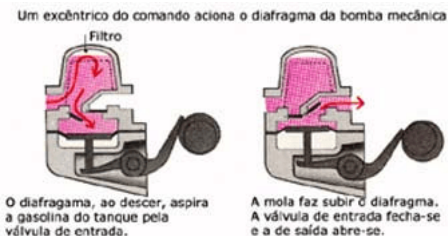
Figura 2: Bomba mecânica em acionamento
