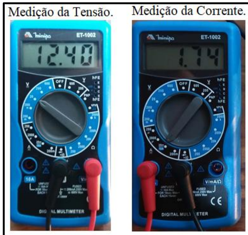
Figura 40- Medições de tensão e corrente elétrica da Luz de leitura.
