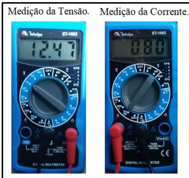
Figura 39 - Medições de tensão e corrente elétrica da Ventilação interna.
