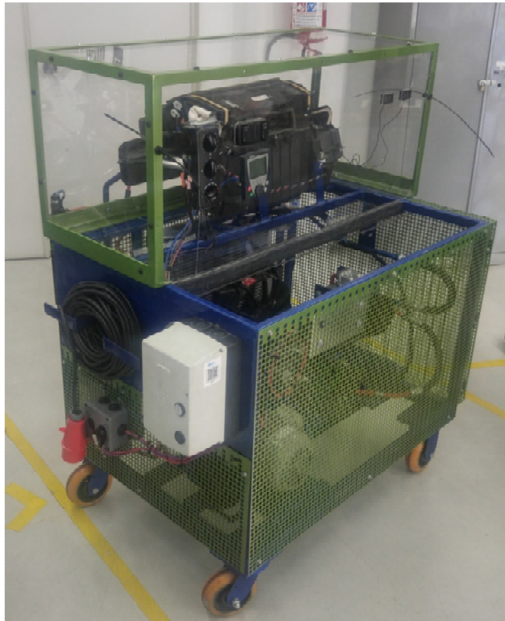
Figura 3 – Giga de teste para sistemas de climatização veicular.
