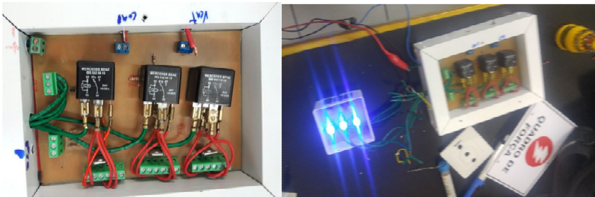
Figura 22 – Quadro com Circuito de Controle I/O
