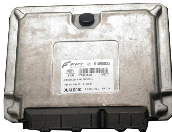
Figura 36 - Nó do câmbio Duallogic®. Fonte: Diagnóstico do câmbio Duallogic® (2007).
