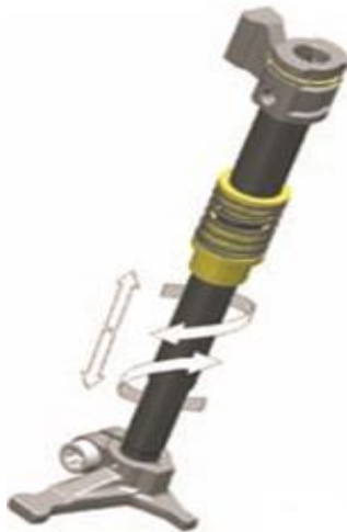
Figura 32 - Eixo de Comando do Câmbio. Fonte: Diagnóstico do Câmbio Dualogic® (2007).
