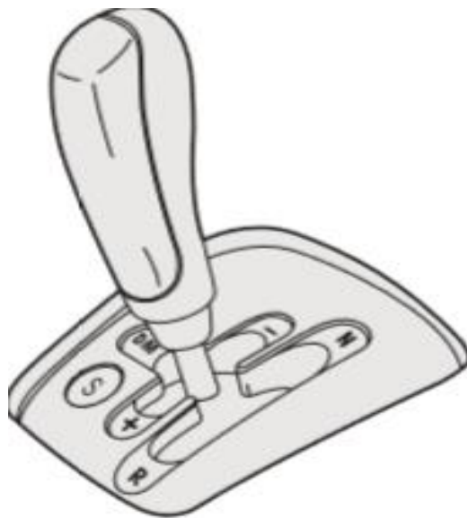
Figura 17 - Joystick (Alavanca) do Sistema Dualogic®.
