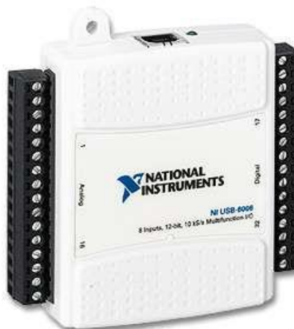
Figura 56 - Placa de aquisição National Instruments NI-USB®.
