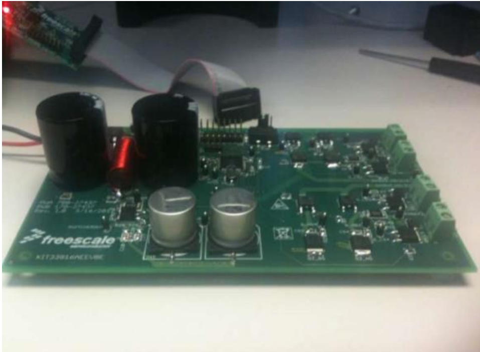
Figura 59 - Placa de controle do MCP33816.
