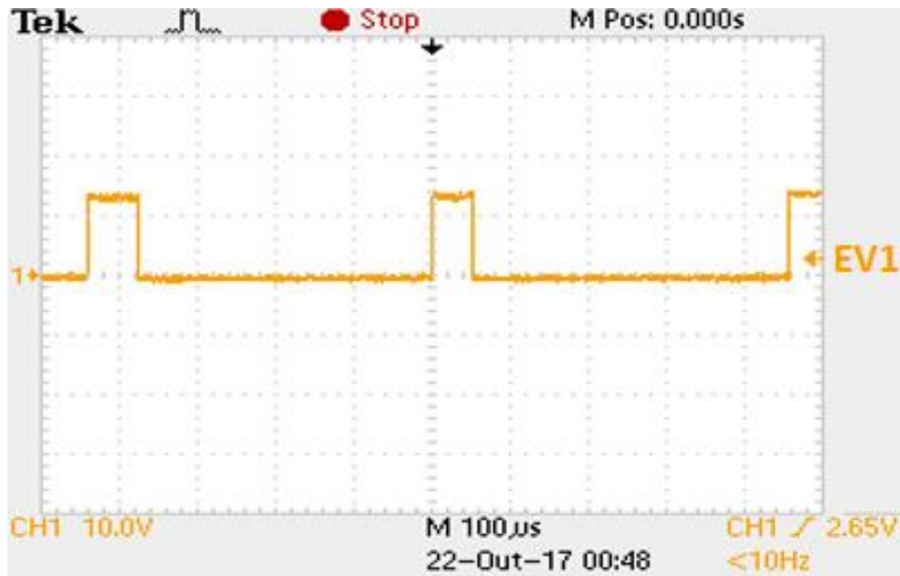
Figura 27 - Tensão Elétrica de 12V da Eletroválvula.
