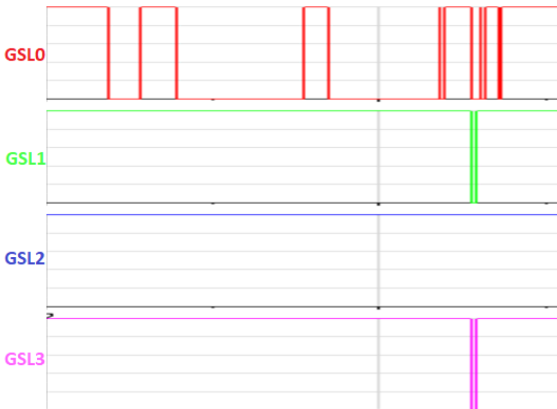
Figura 41 - Sinal dos sensores GSL.
