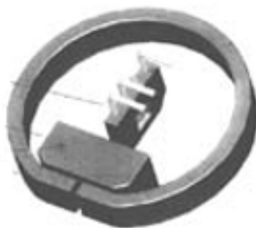
Figura 42 - Acoplamento do sensor de efeito hall ao conjunto magnético. Fonte: Diagnóstico do câmbio Dualogic® (2007).
