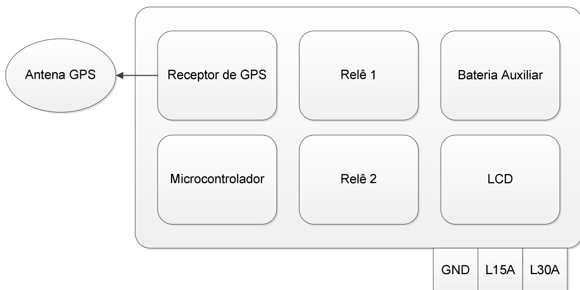
Figura 14. Diagrama do hardware do Sistema de Proteção e Rastreamento (FURLAN, 2014).
