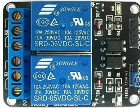
Figura 30. Módulo de relés para chaveamento do sistema de proteção (Extraído de ARDUINO, 2014).
